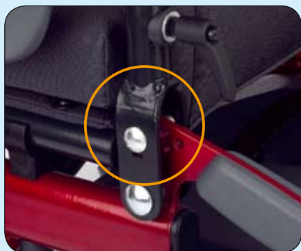
Regulacja kąta nachylenia oparcia od 0° do 30°
